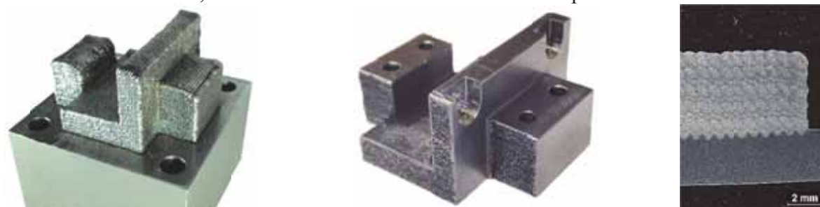
Navařená 3D struktura drátem za pomoci laseru, „vytištěný“ výrobek, příčný řez návarem
