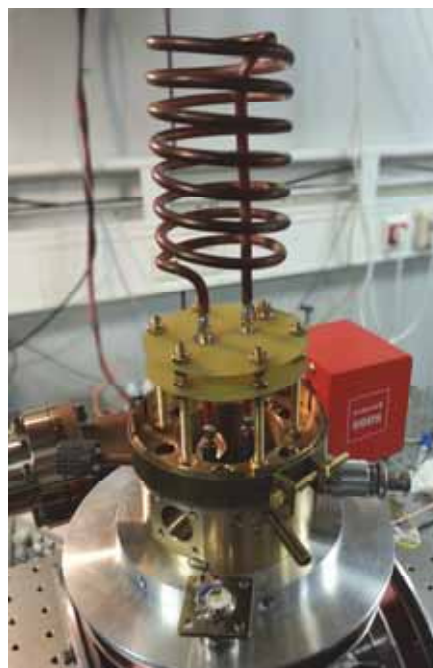
Obr. 2: Naměřené parametry rezonátoru (vlevo) a fotografie mechanického provedení při sejmutém stínícím krytu (vpravo).
