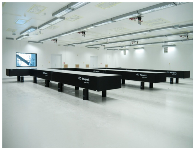
Sestava optických stolů Newport RS2000 se systémem vyladěného tlumení vibrací. Celkové rozměry: 12,6 x 9,9 m (HiLASE)
