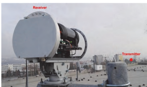
Obr. 2 Experimentální vnější jednotka s optikou Cassegrain
