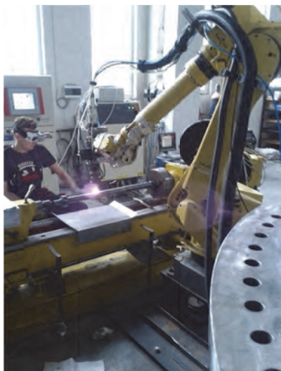
Obr. 1: Proces laserového navařování s využitím 6-ti osého průmyslového robota Fanuc
