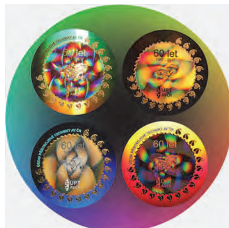
Obr. 2 Pamětní holografická samolepicí etiketa — čtyři pohledy při různém směru nasvícení vzorku a odlišném charakteru použitého světelného zdroje.
