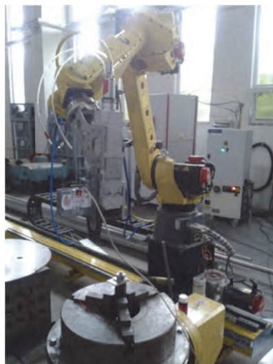
Obr. 1: Proces laserového navařování s využitím 6-ti osého průmyslového robota Fanuc
