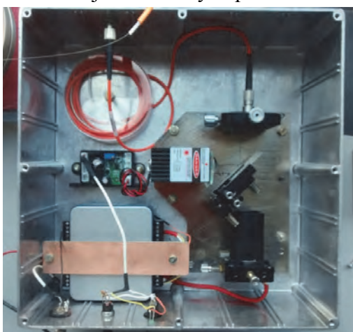
Obrázek 1: Vlevo - Kompaktní systém pro vlnovou délku 532 nm. Laser je uprostřed, nahoře je optické vlákno s kolimační čočkou, dole fotodioda s měřící kartou a mezi nimi dichroidní zrcadlo. Vpravo – Kombinace záběru z CCD kamery na procházející kapénky v čipu a časový průběh fluorescence kapénky zaznamenaný lavinovou diodou pro systém s jedním optickým vláknem. Jasný modrý bod je svazek excitačního laseru.
