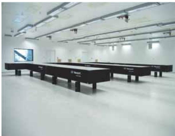
Sestava optických stolů Newport se systémem vyladěného tlumení vibrací. Celkové rozměry: 12,6 x 9,9 m (HiLASE)
