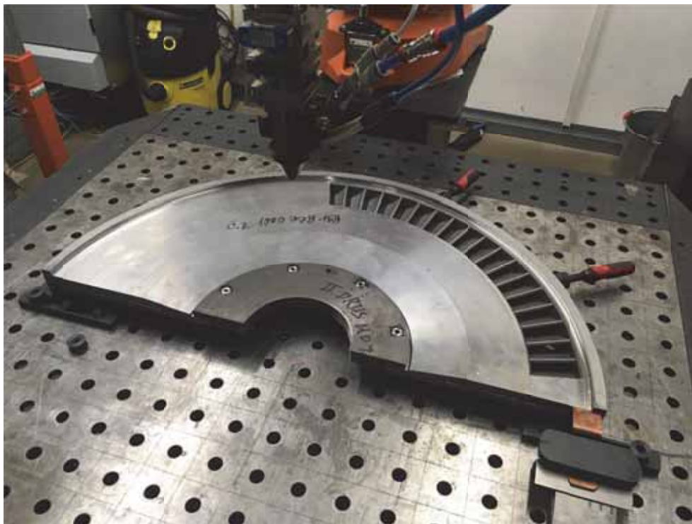
Obr. 2 Svařování rozváděcího kola parní turbíny, heterogenní svar X12Cr13/S355
