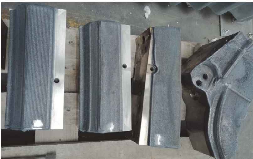
Obr. 3 Aplikace laserového navařování na tvářecí nástroje
