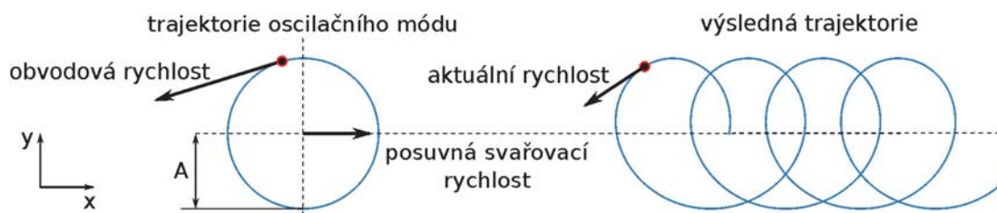
Obr. 1: Trajektorie kruhového oscilačního módu a výsledná trajektorie.
