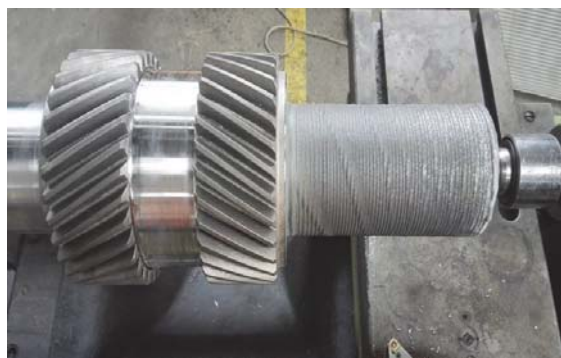
Obr. 2 Typická aplikace laserového navařování – oprava poškozené hřídele
