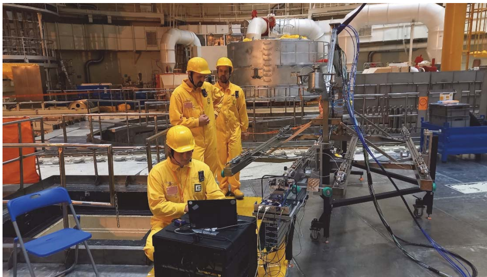
Obr. 2. Fotografie interferometrického systému při měření v JE Temelín.
