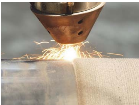
Obr. 2 Typická aplikace laserového navařování – oprava poškozené hřídele
