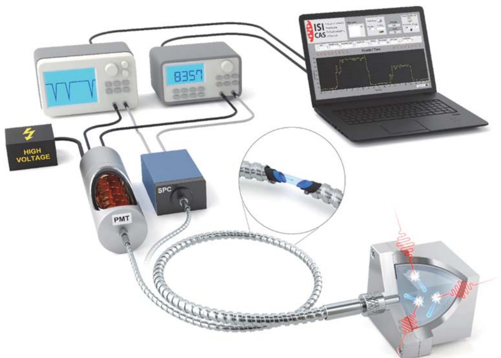
Obrázek 1. Schéma měřicího systému pro měření ionizujícího záření. Měřicí systém obsahuje dvě možné detekční jednotky - SPC a PMT, mnohovidové křemenné optické vlákno a scintilační krystal ukrytý v hliníkovém boxu.
